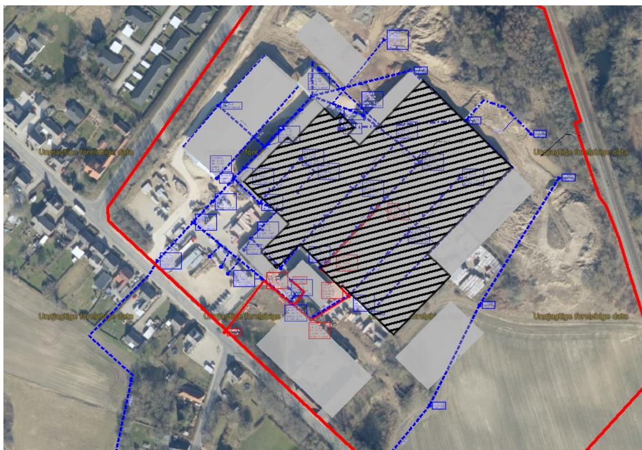
Figur 8: Opdateret afløbsplan for Petersminde Teglværk med angivelse af regnvand (blå) og spildevand (rød). Eksisterende og planlagte tagflader er vist med grå polygoner, mens tagareal der forventes udledt uforsinket er vist med skravering. Projektområdet er vist med rødt polygon.
